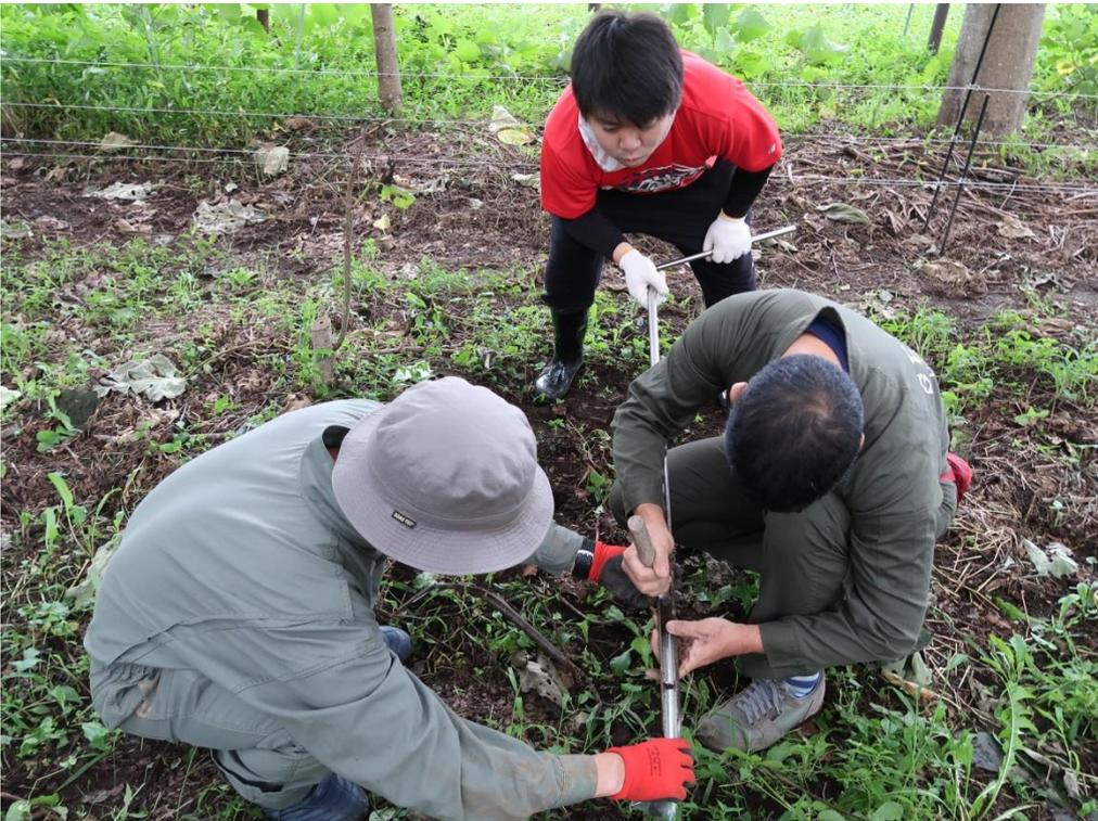
写真-3 橋本家の裏Hでの採土器による土壌試料採取（樹齢約5年）
