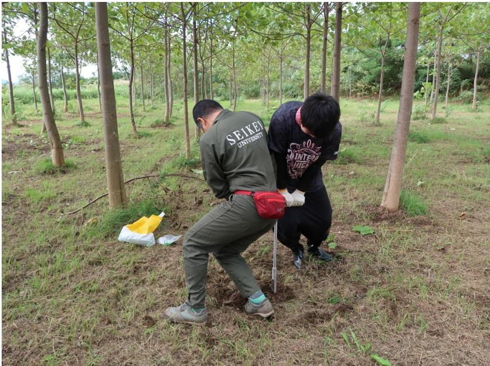
写真-5 猪苗代湖植林地での採土器による土壌試料採取（樹齢約5年）
