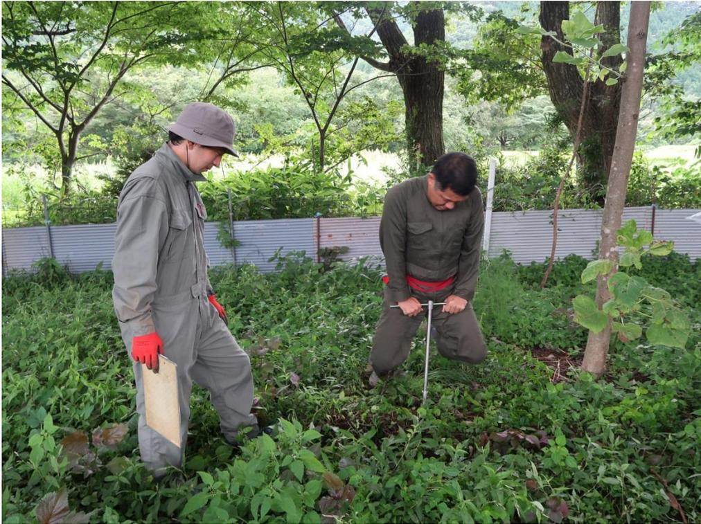
写真-2 橋本家の裏Hでの採土器による土壌試料採取（樹齢約5年）
